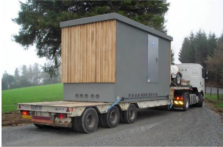
Figure 11: Arrivée d'un poste de livraison sur un site éolien
